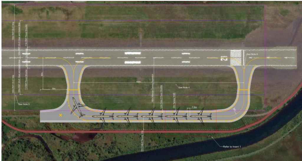
Mynd 2 Líklegasta útfærsla á akbrautinni. Hér má sjá leyfilegan hámarksfjölda millilandaflugvéla á akbrautinni ásamt möguleika á stækkun til suðurs í átt að flughlaði og flugstöð. Rauð lína sýnir líklega staðsetningu öryggisgirðingar og eftirlitsslóða þar utan við eftir hliðrun 1 .
